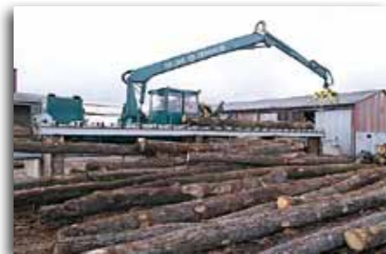
Chariot de tronçonnage.
