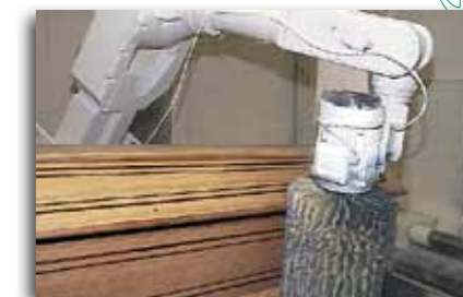
Centre usinage (à gauche). Robot de ponçage (à droite).
