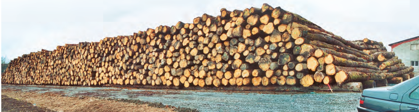
Vue partielle d'un stock de grumes : 12 000 m3 arrosés depuis un bac recyclant en permanence l'eau utilisée.
