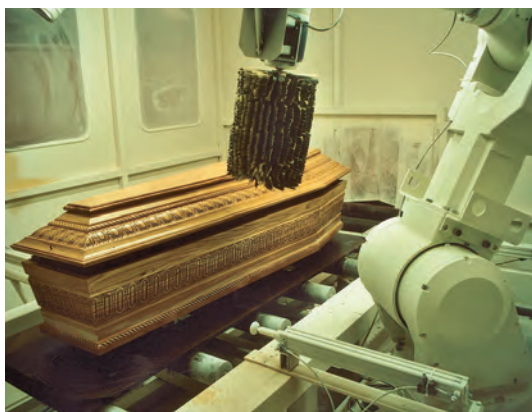
Le robot articulé de ponçage-égrenage Sefic.
